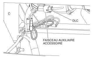
15. Fixer le faisceau auxiliaire accessoire au longeron de châssis du véhicule à l'aide d'une attache de câble, tel que montré.
