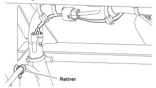
12. Attacher le serre-câbles neuf pour regrouper le faisceau de fils de l'avertisseur sonore et le faisceau de fils du véhicule, tel que montré.
