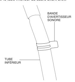
Installer l'avertisseur sonore à un angle de 90 degrés sur le tube inférieur. Brancher le faisceau de fils de l'avertisseur sonore sur l'avertisseur sonore.
