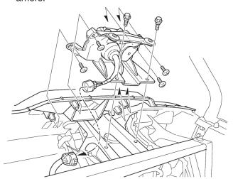
À l'aide du gabarit moulé reposant sur la partie arrière du tableau de bord (noter les différences selon l'année modèle ci-dessous), percer un trou de départ de 16 mm (5/8 po).
