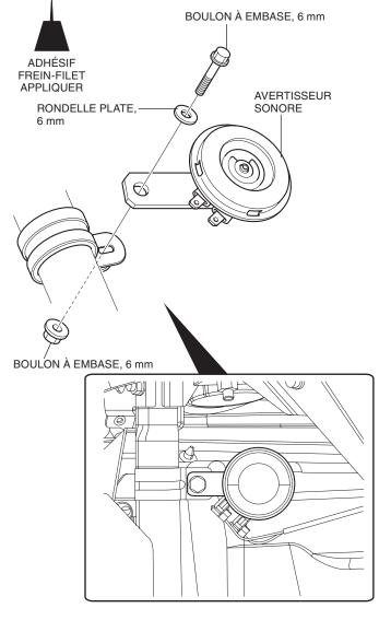
Fixer le faisceau de fils de l'avertisseur sonore au cadre, tel que montré, à l'aide d'une longue attache de câble.
