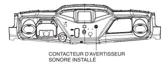
5. Fixer le contacteur d'avertisseur sonore au moyen de deux petites attaches de câble au faisceau du véhicule, tel que montré.
